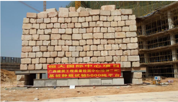
图1 基桩静载荷试验 Fig.1 Pile static load test
