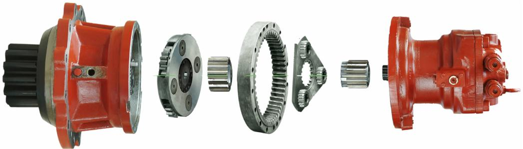
图2 行星减速器结构
