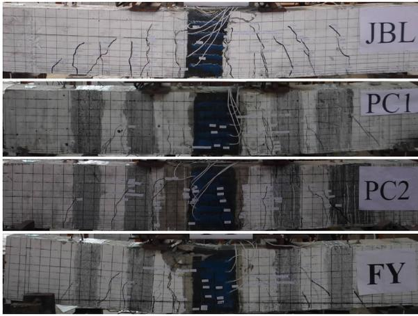
图4 梁的破坏图
