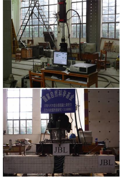
图 2 MTS 电液伺服加载系统
