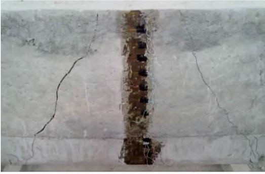
图3 再生碎砖混凝土墙体墙梁试件裂缝
